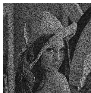
Рис. 2. Результат воздействия импульсным шумом «соль-перец» с вероятностью p=0,5 и аддитивным гауссовским шумом с СКО \sigma=50 на изображение Лена
